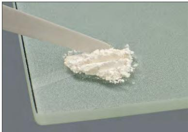
Essendo le masse MARGIN plastificate non occorrono liquidi particolari, si utilizza il VITA MODELLING FLUID contenuto nell'assortimento. Per una miscelazione più omogenea, si consiglia di mischiare in primo luogo le diverse polveri MARGIN (v. "Tabelle di corrispondenza")
