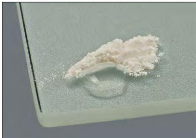
Per la plastificazione delle masse MARGIN il liquido per modellare viene respinto (effetto idrofobo).
