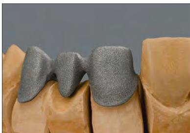
Dopo la finitura sabbare accuratamente la struttura con biossido di alluminio ( $Al_2O_3$ ). Per evitare inclusioni di sabbia, sabbare le leghe con la pressione indicata nelle rispettive istruzioni e con un angolo di incidenza moderato. La pressione di sabbatura e la granulometria dipendono dal tipo di lega. Successivamente pulire la struttura con uno spazzolino sotto acqua corrente oppure con la vaporiera.
